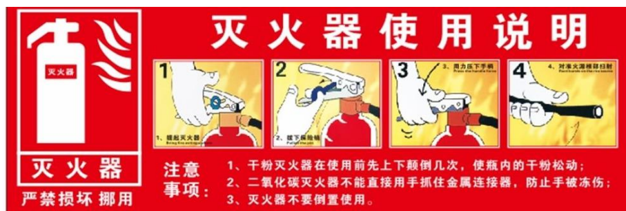
图 2-1 灭火器使用示意图
